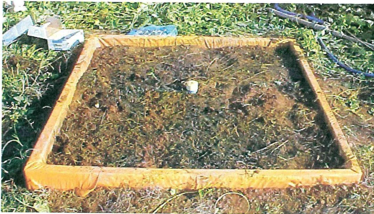
Figura 1 – Lisímetro de pesagem instalado no município de Limoeiro Norte-CE, 2003.
